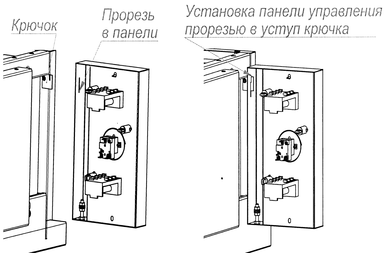
Рис. 5. Технологическое окно для замены контрпетли.
